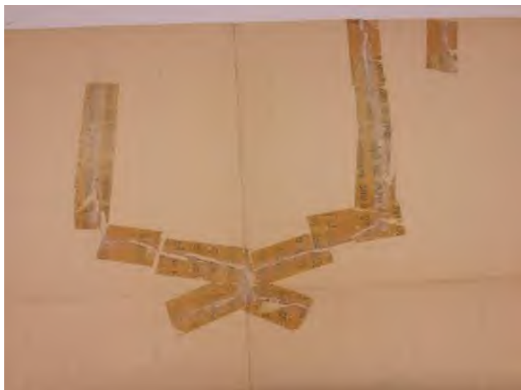
Reparo com fita de PH neutro Fonte: Instituto de Arte Contemporânea - IAC
