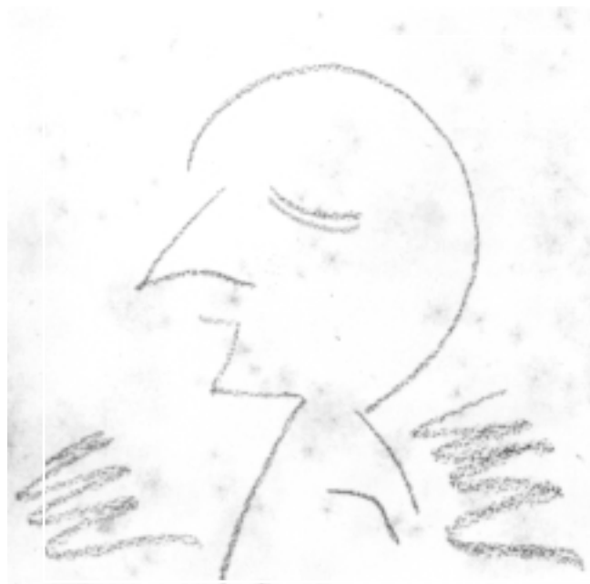
Figura 1. Para propósitos de demonstração, este papel com colagem de gelatina e sobre o qual está um desenho em pastel foi exposto ao ar em um ambiente interno normal e, posteriormente, colocado em uma câmara de umidificação com nível de umidade relativa superior a 90%. O mofo foi visível após três dias. O papel foi removido da câmara depois de 10 dias e colocado em um ambiente em que a umidade relativa era de 50%. Em uma hora, o mofo ativo, que estava em crescimento, começou a enrugur e se enfraquecer; não foi observado qualquer crescimento adicional.
