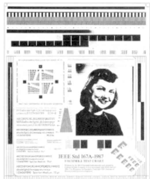
Figura 5. Objeto de teste alfanumérico do RIT de 3" x 3" sobreposto ao gabarito IEEE Std 167-1987.
